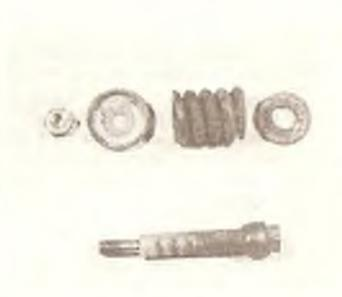
Д/Фотография 19.29B. детали болта крепления опускной трубы выхлопной системы к выпускному коллектору.
