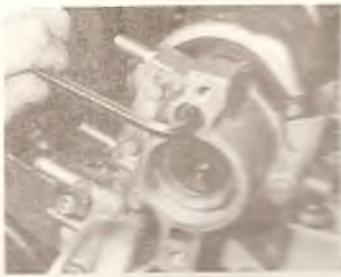
Б Фотография 6.63. Снятие упорного винта с корпуса выпускного патрубка системы охлаждения.
