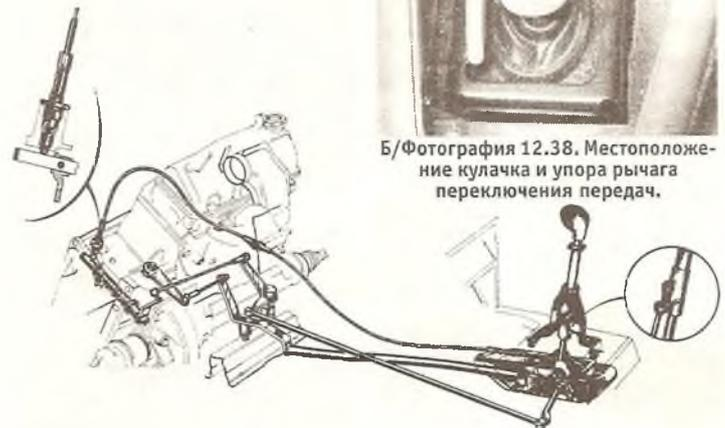
Б/Рис.12.54. Рычажный механизм переключения передач на последних моделях, оборудованных тросом фиксатора передачи заднего хода.
