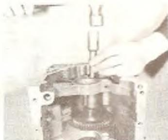
Б/Фотография 5.11D...и наконечник с помощью трубчатого бороздки забить на место стопорное кольцо.
