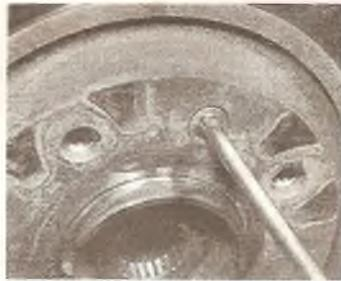
Б/Фотография 16.26. Снятие одного из крепежных винтов тормозного диска.
