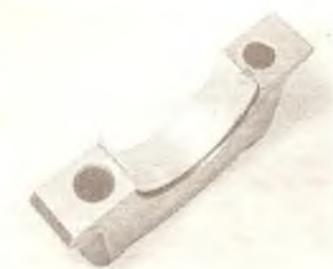
Д/Фотография 22.56. Коренная крышка с нижним вкладышем коренного подшипника.
