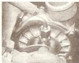
Д/Фотография 6.47А. Штуцер смазочной трубки турбоагнетателя.
