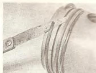
Д/Фотография 24.14. Снятие поршневых колец с помощью старого щупа толщиномера.
