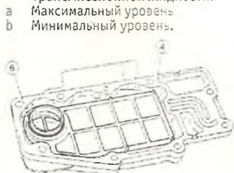
**Б/Рис.12.72.** Корпус (4) фильтра и уплотнительное кольцо.
