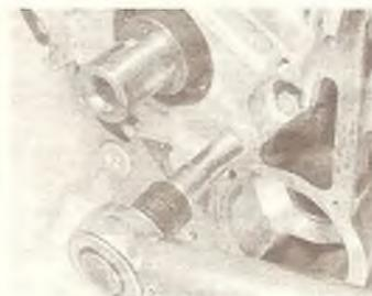
Д/Фотография 26.26. Затяжка болтов корпуса переднего сальника коленвала.
