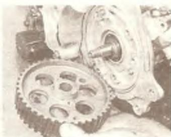
Д/Фотография 22.31В... и снять звездочку ТНВД.
