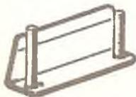
Д/Рис.1.4В. Инструмент для удерживания плунжера натяжителя (раздел 5).
