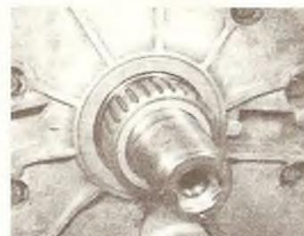
Б/Фотография 7.17В... и снять ленту с ведущей шестерни.
