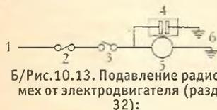
Б/Рис.10.13. Подавление радиопомех от электродвигателя (раздел 32):
