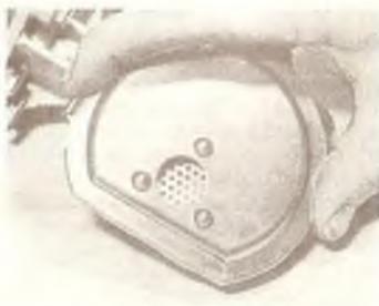
Д/Фотография 14.10А. Снятие крышки масляного насоса...
