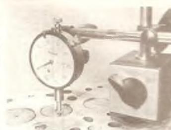
Д/Фотография 10.14. Проверка глубины утопленности головок клапанов.
