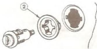
Б/Рис.12.143. Переходник (2) для установки старого цилиндра замка на новую дверь.
