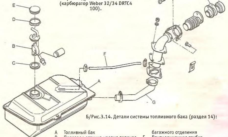
Б/Рис.3.14. Детали системы топливного бака (раздел 14):
