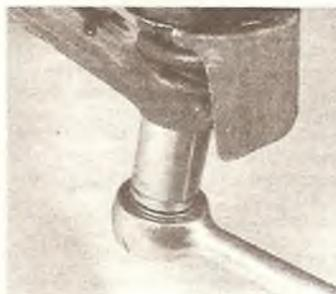
Б/Фотография 12.16А. Снятие гайки шаровой опоры поворотной цапфы.
