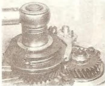
Б/Фотография 12.56. Снятие гайки ведущего вала.
