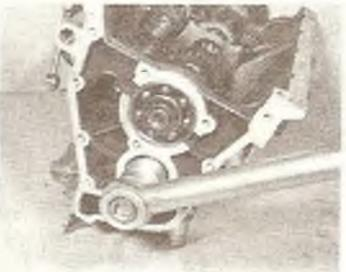
Б/Фотография 5.23В...после чего затянуть гайку вторичного вала.
