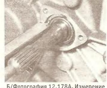
Б/Фотография 12.178А. Измерение расстояния между контактной поверхностью и наружным кольцом подшипника.
