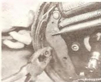
Б/Фотография 8.17. ... и установить пружины, фиксирующие колодки, вместе с пальцами и шайбами.
