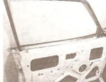
Б/Фотография 10.4. Снятие уплотнителей дверного стекла.
