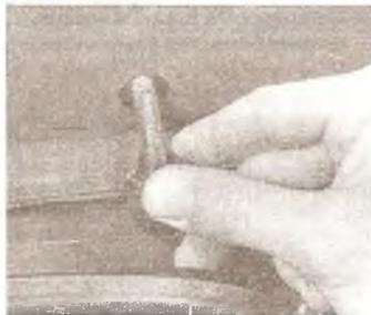
Б/Фотография 19.19. Отсоединение трубки омывателя заднего стекла.
