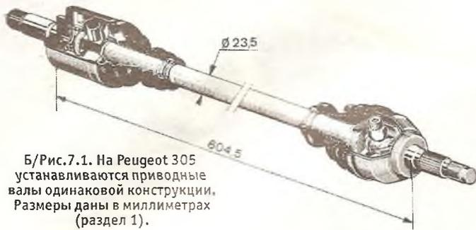
Б/Рис.7.1. На Peugeot 305 устанавливаются приводные валы одинаковой конструкции. Размеры даны в миллиметрах (раздел 1).
