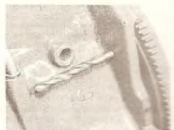
Фотография 22.26. Вставить сверло так, чтобы оно зашло в отверстие на маховике для установки в.н.т.
