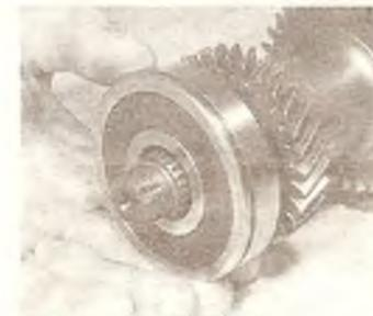
Б/Фотография 12.104. Снятие с выходного вала заднего подшипника...
