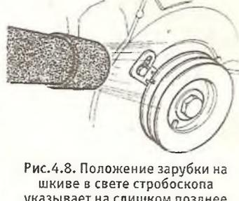
Рис. 4.8. Положение зарубки на шкиве в свете стробоскопа указывает на слишком позднее зажигание. Необходимо повернуть трамблер так, чтобы зарубка на шкиве совместилась с левой зарубкой на установочной шкале (раздел 10).
