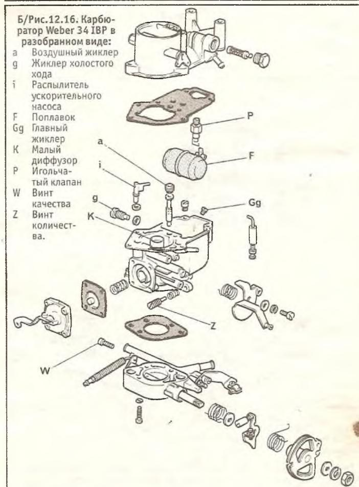
Б/Рис.12.16. Карбюратор Weber 34 I BV в разобранном виде:
