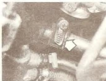
Д/Фотография 6.38D. Место подсоединения обратного масляного шланга к трубке турбоагнетателя (показано стрелкой).
