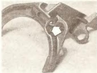
Б/Фотография 12.119. Вилка включения передач. Видны шарик и пружина фиксатора (показаны стрелкой).
