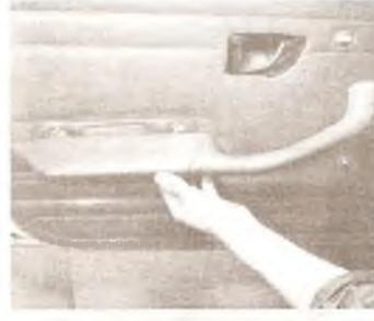
Б/Фотография 9.5В... и затем 2 нижних винта. Снять подлокотник.
