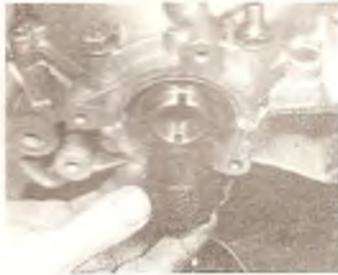
Б/Фотография 12.82В. Снятие ведущей шестерни привода спидометра.
