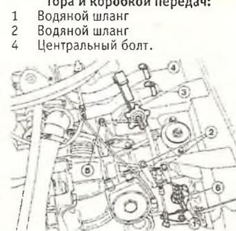
**Б/Рис.12.83.** Точки отсоединения при снятии автоматической коробки передач:
