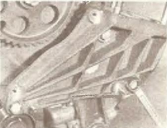
Б/Фотография 7.40. Установка опорного кронштейна двигателя.
