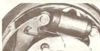
Б/Рис.8.22. Установить пружину (1) и нажать на рычаг регулятора (2) по направлению к тормозной колодке (раздел 8).
