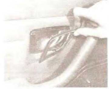
Б/Фотография 9.3... и снять облицовку ручки открывания дверной защелки.
