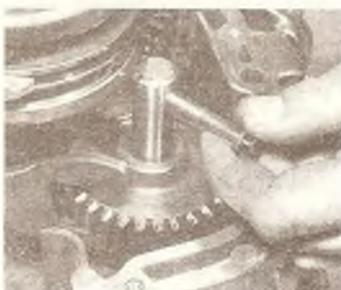
Б/Фотография 12.69. Снятие оси промежуточной шестерни заднего хода.
