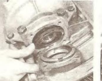
Б/Фотография 5.30А. Установка регулировочных шайб и крышки с новым уплотнительным кольцом.
