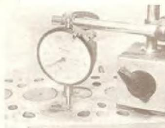
Д/Фотография 10.11В... и проверить величину выступающих вихревых камер.
