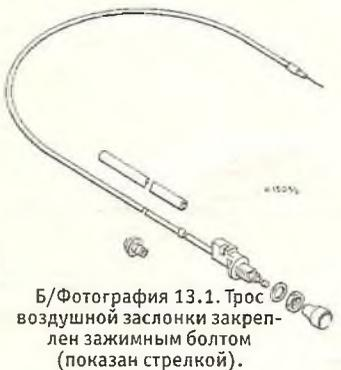
Б/Фотография 13.1. Трос воздушной заслонки закреплен зажимным болтом (показан стрелкой).
