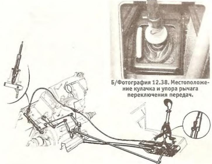
Б/Фотография 12.38. Местоположение кулачка и упора рычага переключения передач.
