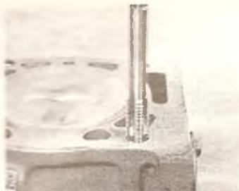
Д/Фотография 26.34. Очистка отверстий под болты головки цилиндров с помощью метчика.
