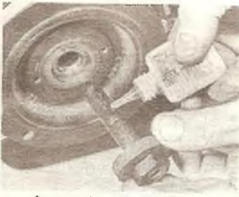
Фотография 26.62А. Перед установкой болта шкива коленвала нанести на его резьбу немного жидкости для фиксации резьбовых соединений.
