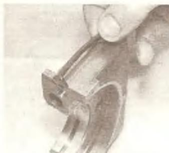
Б/Фотография 7.16А. Установка бокового уплотнения на крышку коренного подшипника N 1.
