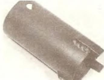
Д/Фотография 4.22А. Самодельный инструмент для снятия опорной резинки подушки двигателя.
