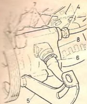
Б/Рис.12.107. Снятие насоса рулевого гидроусилителя (8):
