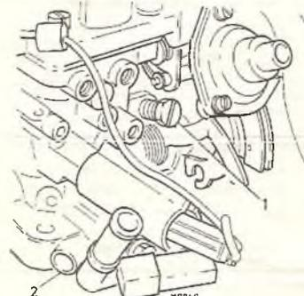
Б/Рис.12.26. Регулировочные винты на карбюраторе Weber 32/34 DRTC4 100:
