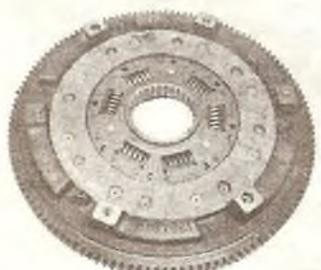
Б/Фотография 5.8В... установить на него ведомый диск сцепления и, после установки трех цилиндрических пружин...
