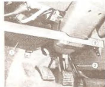
Б/Рис.11.2. Снять полку (1), кожу рулевой колонки (2) и болты (3) (раздел 12).
