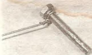
Фотография 6.69. Самодельное приспособление для установки в.м.т.
