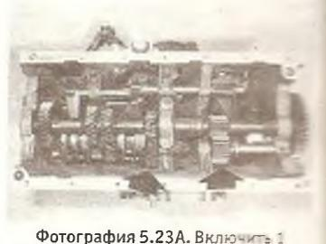
Фотография 5.23А. Включить 1 передачу и одновременно ввести в зацепление промежуточную шестерню заднего хода (обе шестерни показаны стрелками) для того, чтобы заблокировать коробку...
